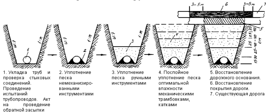
Рис.2. Последовательность работ по восстановлению дорожной конструкции
