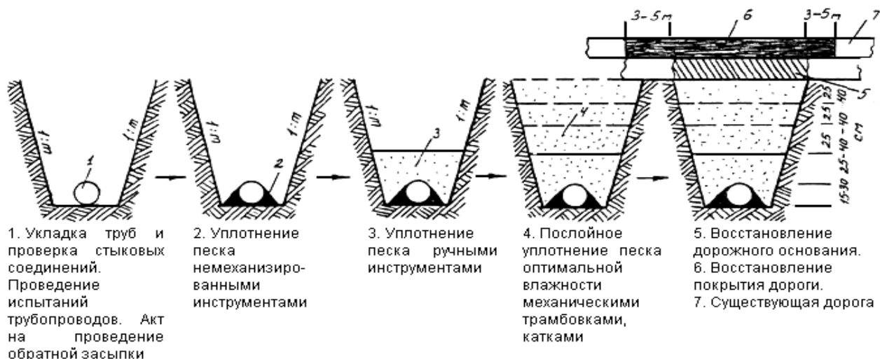
Рис.2. Последовательность работ по восстановлению дорожной конструкции
