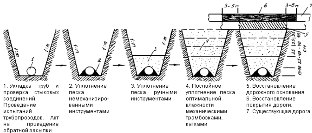
Рис.2. Последовательность работ по восстановлению дорожной конструкции
